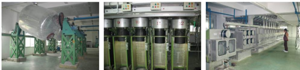
Сырье (отходы ПЭТ в виде чипсов, бутылочных флэксов или волокнистых материалов) → Сушка → Экструзия → Фильтрация → Образование трубообразной заготовки из расплава → Прядение нитей расплава → Прохождение фильеры → Закалка (охлаждение) → Обработка замасливателем → Натяжение и вытяжка → Подача → Загрузка в контейнеры для сбора жгута
