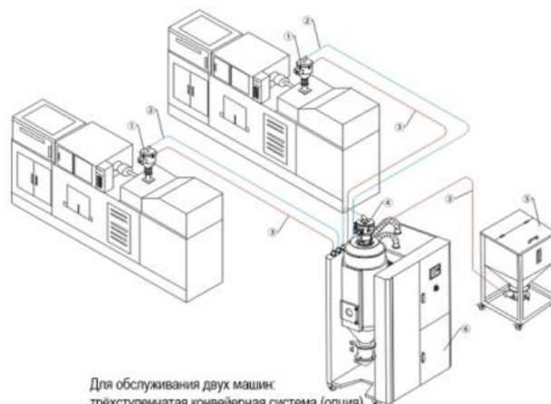
Для обслуживания двух машин: трёхступенчатая конвейерная система (опция)
