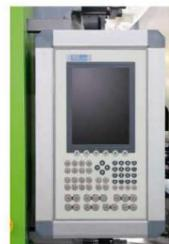
В системе управления применяется мощный компьютер известной марки Euro, который прост в эксплуатации и может осуществлять синхронизацию управления машиной и роботом в режиме реального времени.
