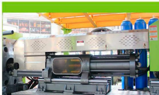
Аккумулятор с сервоклапаном используется для управления впрыском, что делает подачу более точной и сокращает время рабочего цикла. Специализированный шнек для PET, позволяет увеличить скорость и качество плавления, снижает температуру пластификации и значение AA, что значительно улучшает формовку и прозрачность готовых изделий.
